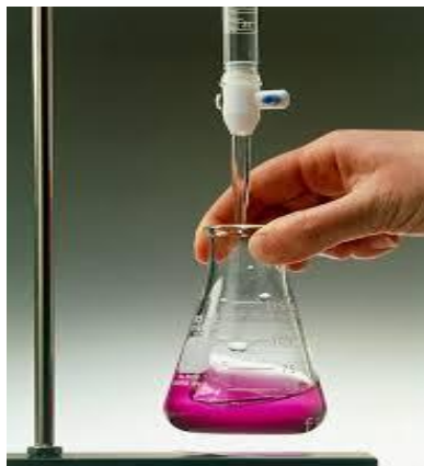
Figura 2: Imagem do aparato utilizado em uma titulação ácido-base.
